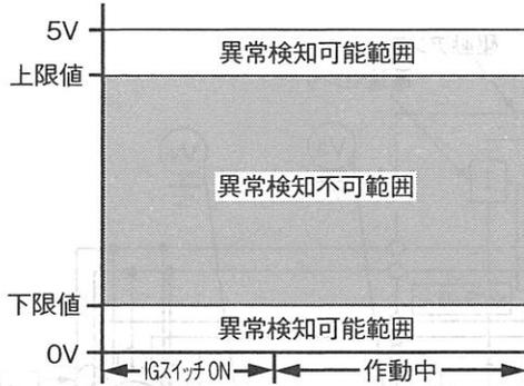
図2 トルク・センサの信号電圧特性
