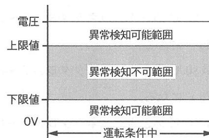
[No. 5] 図1に示す異常検知範囲をもつ図2の水溫センサ回路の異常検知に関する記述として、不適切なものは次のうちどれか。
